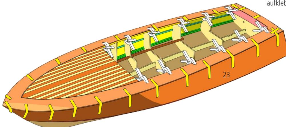
28 Die Spanten 1 - 11, die Leisten 17 und die restlichen Rumpfborteile überschleifen damit diese Teile die gleiche Höhe wie die Rumpfsseitenteile 23 haben. Das Deck 32 auf den Rumpf aufleimen und mit Klammern und Klebestreifen sichern.
