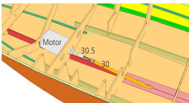
23 Die Schiffswelle mit dem Wellenrohr 30 in den Rumpf
