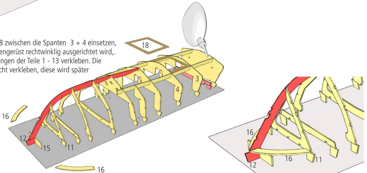
6 Die beiden Rundungen 16 werden in die Aussparung von Kiel 12 und in den Spant 11 gesteckt und liegen auf der Stütze 15 auf.
