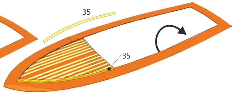
27 Vorne in das Deck 32 die Leisten 34 einkleben und dann das Bootsdeck 33. Über die Teile 32,33 und 34 das Gewebeband als Überbrückung aufkleben. Das fertige Deck drehen.
