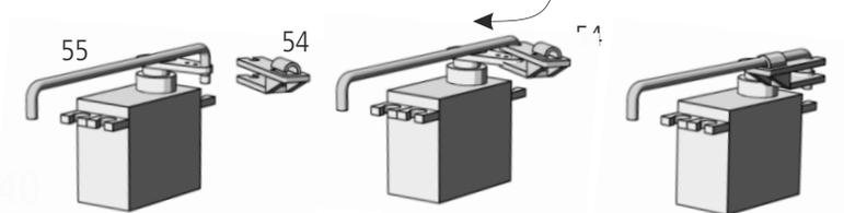
Den Abstand zwischen den Bohrungen der Ruderhörner messen und einen Draht mit  $\varnothing 1,5$  mm in dieser Länge auf beiden Seiten rechtwinklig abbiegen. Die abgewinkelten Enden sind 8 mm lang. Den Draht durch die Ruderhörner stecken, den Clip 54 auf das Ruderhorn und in den Draht schieben und schwenken, damit die Lasche auf dem Draht 55 einrastet. Auf dem Ruderhorn 53 wird der Clip genauso befestigt.
