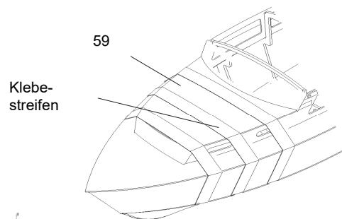
Kleben Sie das vordere Kajütdach 59 auf die Dachbalken 28, 29, Teil 30 und die Seitenwände 25. Das Dach mit Klebestreifen fixieren.
