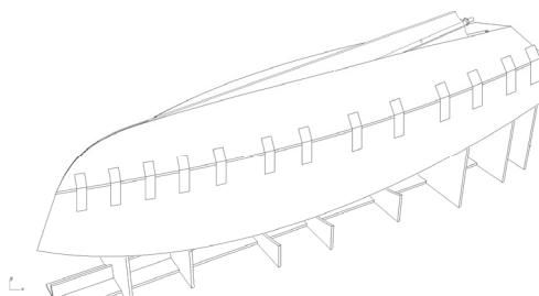
Drehen Sie das Boot um und verkleben Sie alles von innen. Die Bordwand sollte nur mit den Decksstringern fest geklammert werden, nicht mit den Spanten. So vermeiden Sie spätere Beulen im Rumpf durch Schrumpfen des Klebers.
