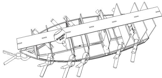
Die beiden Seitenplatten 24 im vorderen Bereich ca 45° spitz anschleifen.
