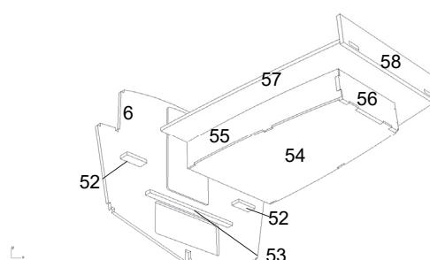
Die Teile 52 und 53 in die Aussparungen vom Spant 6 auf der Plichtseite (hinten) einkleben.
