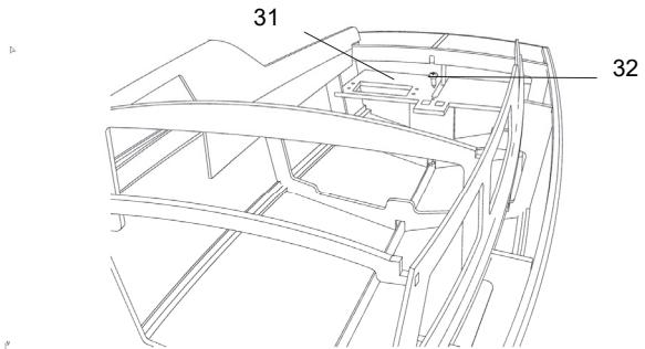
Geben Sie Klebstoff auf die Spant- und Stringeroberseiten, sowie auf den Decksunterzug.
