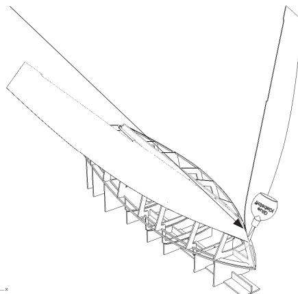
Nach dem Aushärtenbiegen Sie beide Platten auf die Spanten und Stringer. Befestigen Sie die Platten mit großen Klammern auf einigen Spanten.
