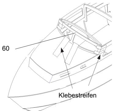
Das Frontfenster 60 mit Klebestreifen mittig auf dem Kajütdeck fixieren. An den Seiten mit Klebestreifen an der Kajütwand fixieren und einkleben.
