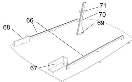
Den Mast 70 in den Mastfuß 69 einkleben. Der Lampenhalter 71 wird von vorn in den Ausschnitt geschoben und eingeklebt.
