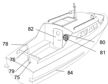
Die beiden Steuerrad-Kastenteile 80 übereinander kleben und hinten rechts an die Rückwand auf die Bohrung kleben. Kleben Sie die Tür 82 auf den Einsatz von Spant 6.
