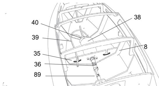
Den Motorträger mit montiertem Motor und Welle als Einheit auf den Rumpfboden einkleben.
