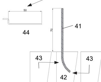
Biegen Sie die Ruderwelle 41 im Bereich des Ruderblattes 42 rund und kleben Sie diese mit 2-K-Kleber in das Ruderblatt ein.
