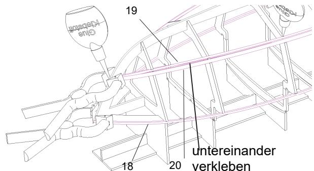
Verfahren Sie ebenso mit den Bodenstringern 19 (Kiefernleiste 3x3 mm) und Kimmstringern 20 (Kiefernleiste 2x5 mm), anschrägen, vorn festkleben und dann in die restlichen Spanten einkleben.
