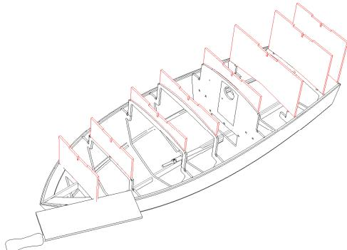
Drehen Sie das Boot um und sägen Sie die Hilfspanten ab. Verschleifen Sie die Sägeschnitte, wenn nötig.
