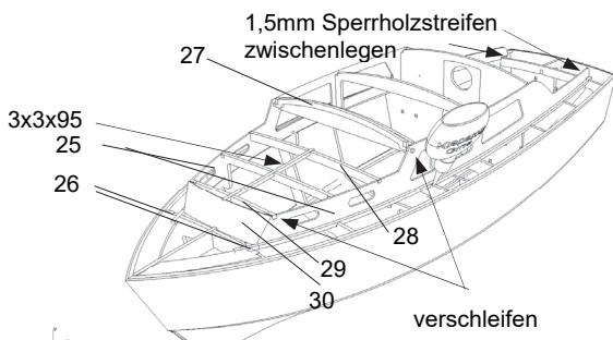
Teil 30 unten auf den mittleren Zapfen auflegen und mit Klebestreifen an den Seitenwänden befestigen und verkleben.
