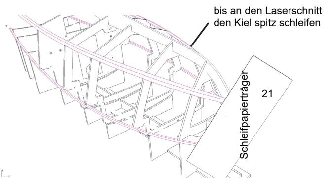
Den vorderen Bereich des Kiels vom Deck an bis zum Laserschnitt an spitzen.
