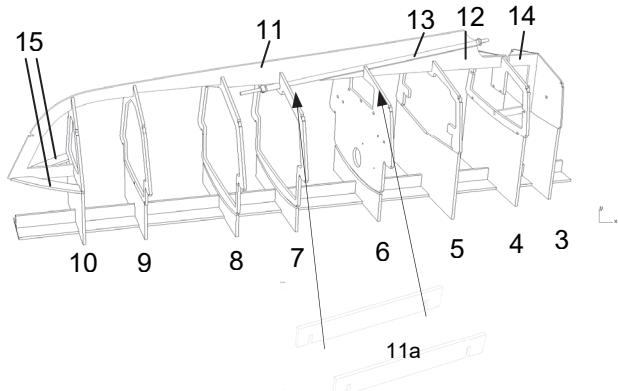
Zum Ausrichten des Abstandes die Abstandshalter 11a auf Spant 6 und 7 neben dem Kiel aufstecken. **Nicht einkleben.**
