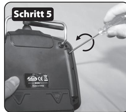
**NOTIZ:** Wenn Sie von MODE 1 in MODE 2 zurückwechseln möchten, müssen Sie zuerst, unter der Batterieabdeckung den MODE Knopf in MODE 2 schieben. Schrauben sie die beiden linken Schrauben heraus, und schrauben die beiden rechten Schrauben hinein. Verstellen Sie die rechte und linke Schraubenspannung, um die Segelhebel- und Ruderfederspannung einzustellen, wie Sie dies möchten.
