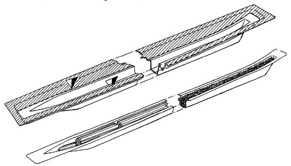
Befestigen Sie das Mittelteil wieder auf dem Rumpf und legen Sie diesen auf den Kopf. Zeichnen Sie am Rumpf die gezeigten Maße an und kleben Sie dann den Kiel entlang der Mittellinie an den Rumpf. Lassen Sie alles gut trocknen. Die Kante des Auflagerandes des Kiels am Rumpf kann schräg verschliffen und verspachtelt werden.
