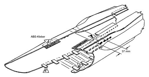
Wenn trocken verschleifen Sie den überstehenden Klebstoff mit nassem Schleifpapier, bis die Verbindungskante glatt ist. Jegliche Spalten können mit Plastikspachtel gefüllt werden. Ebenso kann man aus ABS-Kleber und ABS-Spänen einen eigenen Spachtel in einem kleinen Marmeladeglas ansetzen. Es dauert allerdings einige Zeit, bis der Kunststoff im Kleber sich so weit gelöst hat, dass er sich verarbeiten lässt.
