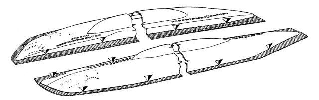
Mit Hilfe von zuerst grobem und dann feinem Sandpapier schleifen Sie die von der Innenseite erhöhten Flutöffnungen und Details auf. Schleifen Sie bis zur Wand hinunter. Auch beim Bau des Standmodells empfehlen wir, die Öffnungen aufzuschleifen, aber im Gegensatz zum Fahrmodell, wo diese offen bleiben sollen, werden Sie beim Standmodell dann mit einem schwarzlackierten Teil wieder hinterklebt. Somit sind die Öffnungen nach unserer Ansicht sauberer, als wenn man sie zulässt und nur ausmalt.
