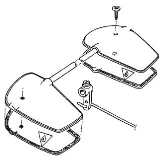
Der Draht (37) kann dann gleich in das Innenrohr des Bowdenzuges geschoben werden, nachdem noch vorher ein Schlauchstück (39) und einen Stellring (38) aufgeschoben wurde. Beachten Sie hierzu auch den Bauplan. Die Justierung erfolgt später.
