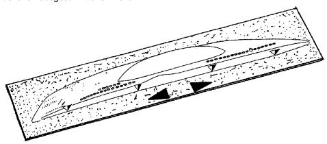
Biegen Sie einige Streifen von 12 x 1,5 mm ABS dem Rumpfradius entsprechend rund. Schneiden Sie diese zu 40 Stücken von 25 mm Länge zu (3). Diese werden in die Innenseite der unteren Rumpfseite geklebt.
