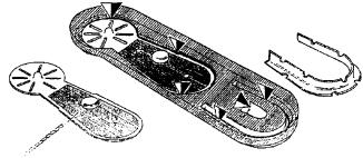
Verschleifen Sie die Kanten, bis das Deck sauber in das untere Turmteil passt. Kleben Sie es dann in den Turm und lassen Sie es trocknen. Feilen Sie den Ran hinunter bis auf Deckhöhe, aber seien Sie vorsichtig, dass Sie keine Details mit anschleifen. Schneiden Sie am Boden des unteren Turmteils 4 Ausschnitte wie gezeigt.
