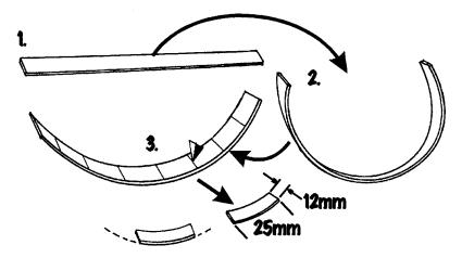
**Tipp!** Zum Biegen von Plastikstreifen ziehen Sie diese über die Tischkante Ihrer Werkbank, bis sie sich einrollen. Wiederholen Sie dies so lange, bis der richtige Radius erreicht ist.
