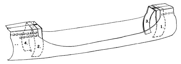
Mutternfixierung: setzen Sie das Mittelteil wieder auf den Rumpf und halten Sie es mit Klebeband. Bohren Sie 4 Löcher von 3 mm Durchmesser durch das Mittelteil in die Streben. Entfernen Sie das Mittelteil wieder.
