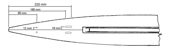
Zum Anlegen verwenden Sie einen Rechten Winkel, den Sie senkrecht am Heck anlegen. Für die zwei Bohrungen für die Ruderkoker verwenden Sie zuerst einen 2 mm Bohrer und bohren dann auf 4 mm auf. Bei der Aussparung für die Stevenrohre empfehlen wir ebenso an den Endpunkten klein anzubohren und dann bis auf 7 mm aufzubohren und zu feilen.
