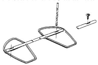
Kleben Sie die Ruderhälften zusammen und lassen Sie sie trocknen. Prüfen Sie die Ausrichtung der Ruder, indem Sie sie auf eine ebene Fläche legen. Verschleifen Sie die Kleberänder sorgfältig.
