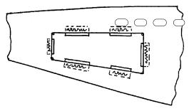
Für den Deckel schneiden Sie 3 Streifen aus, die Sie senkrecht auf die Innenseite des Deckels kleben. Der Deckel soll dann mit der Oberkante im Rumpf eingehakt werden und an der Unterkante durch Hochdrücken eingehängt werden.
