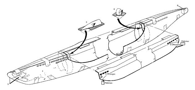
Geben Sie nun ABS-Kleber auf die 5 Verbindungsstücke des Mittelteils und setzen Sie das Backbord-Mittelteil wieder ein. Lassen Sie den Kleber trocknen.
