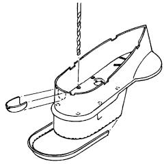
Hier nochmals der gesamte Zusammenbau. Kleben Sie den oberen Rand (66) bündig mit der Oberkante an.
