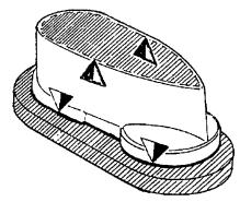
Feilen Sie im Turmdeck (67) zunächst die 8 erhöhten Streifen eben mit dem Deck. Dann schneiden Sie den Innenrahmen (69) von außen von der Außenseite her aus. Den Kompass (68) bohren Sie zunächst mit 3 mm, dann schneiden Sie ihn von der Außenseite her aus. Die Rückseite des Kompasses wird dann von der Innenseite her ausgeschnitten.
