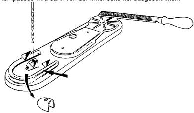
Dann Drehen Sie das Formteil um und schneiden das Turmdeck von der Innenseite her aus. Wiederholen Sie dies mit dem Innenrahmen (69) und verwenden Sie eine kleine Rundfeile um die halbrunden Öffnungen herauszuarbeiten. Bohren Sie 4 x 3 mm Löcher in die Periskop-Erhöhung auf der Mitte des Decks.
