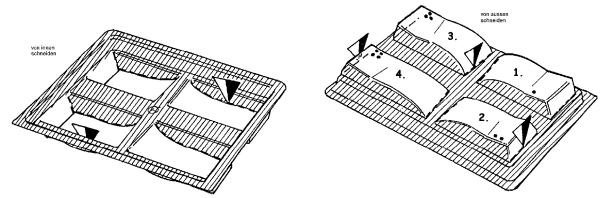
Schneiden Sie nun die 4 Deckelbefestigungsstreben aus. Schneiden Sie hierzu zuerst die geschwungenen Linien von der Innenseite entlang und die Querlinien von der Außenseite. Die Teile sind mit Punkten von 1 bis 4 markiert.
