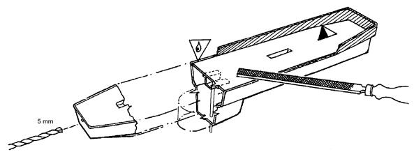
Bohren Sie nun noch 8 kleine Bohrungen von 2 mm Durchmesser rund um das Belüftungsrohr sowie je eines vorne und hinten in das Turmdach des Fluttanks.
