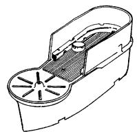
Bohren Sie 6 x 3 mm Löcher von unten in das Deck, jedoch nicht in die innere Stufe, damit sie von aussen nicht sichtbar sind. Kleben Sie das Kompassteil (68) an.
