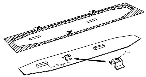
Bohren Sie an gleicher Stelle in das Oberteil ein 5 mm Loch für das Entlüftungsrohr und kleben Sie das Rohr in Oberschale und Halterung mit Epoxidkleber und gleichzeitig den Boden mit ABS-Kleber in das Oberteil. Schneiden Sie den Rand des Oberteiles ab und verschleifen Sie ihn eben mit dem Boden. Bohren Sie für die Anschlussrohre (56) vorne und hinten je ein 5 mm Loch ganz dicht am Boden in die Stirnseiten und kleben Sie diese ein.
