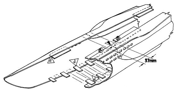
Beginnen Sie im Bodenbereich auf jede Rumpfhälfte 20 gebogene Streifen (3) mit einem Abstand von ca. 35 mm zwischen jedem Teil zu kleben und zwar so, dass diese sich gegenseitig verzahnen. Kleben Sie zwei 10 mm Streifen (4) in den Bugbereich und dann 5 weitere in den mittleren Bereich, wie gezeigt. Gehen Sie sicher, dass ein 37 mm Spalt an der Schnittlinie für die Formstücke (7) verbleibt.
