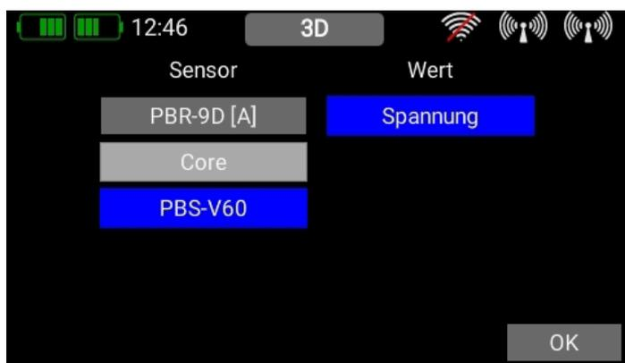
In diesem Beispiel soll der **PBS-V60** Spannungssensor dazu verwendet werden die Motorleistung zu drosseln, wenn der Akku leer wird. Sie können dem Telemetrie Geber unter dem Feld **Name** umbenennen.
