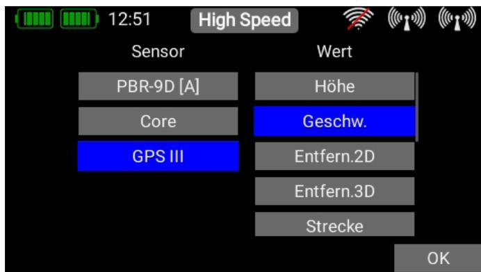
In der linken Spalte stehen alle angeschlossenen Sensoren und in der rechten Spalte alle Werte, die diese Sensoren beinhalten. Der eigens entwickelte **P<sup>2</sup>BUS** kann bis zu 255 Sensoren mit je 32 einzelnen Werten übertragen – und das mit einer Geschwindigkeit von bis zu 800 Werten pro Sekunde!
