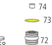
56 Der Lampenhalter wird aus den Teilen 68 - 70 zusammengeklebt. Den Draht 71 durch die Öse 67 schieben und knicken. Den Draht durch den Lampenhalter 68 und durch Teil 66 schieben. Den Lampenhalter 68 an den Draht kleben.
