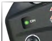
Wenn die Status-LED rot blinkt, sind eventuell die Batterien des Senders schwach, entladen oder nicht richtig installiert. Ersetzen Sie sie mit neuen oder frisch geladenen Batterien. Die Anzeigelampe zeigt nicht den Ladezustand der im Modell installierten Batterie an. Mehr Informationen über Sender, Statusanzeige und LED-Signale finden Sie auf Seite 28 im Abschnitt Fehlerbehebung.
