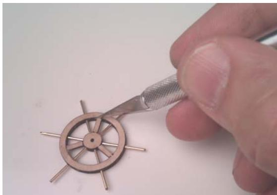
Trennen Sie dann sehr vorsichtig die Hilfsspeichen aus dem unteren Laserteil heraus. Dann verschleifen Sie die Holzteile sorgfältig.
