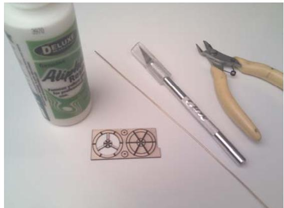
Für den Zusammenbau des Steuerrades benötigen Sie das Laserbrettchen, ca 12 cm Messingdraht 1 mm, sowie Weißleim oder Aliphatische Leim, ein Balsamesser, einen Seitenschneider und etwas Schleifpapier.
