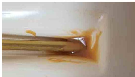
Lorsque le collage du tube d'étambot est sec, placez et collez l'axe de gouvernail et le support de batterie dans la coque avec UHU Plus Acrylit.
