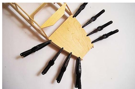
Wenn der Kleber getrocknet ist genau so mit der anderen Seite verfahren. Anschließend von innen kleben und mit Klemmen sichern.
