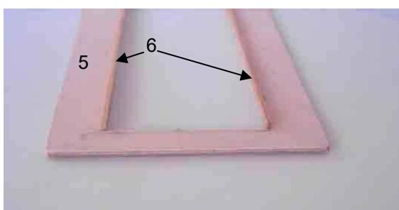
Collez maintenant la hiloire (10 à 13) contre les baguettes de telle façon que les bandes de contreplaqué soient jointives et dépassent sur le pont. On évite ainsi l'entrée d'eau dans la coque.
