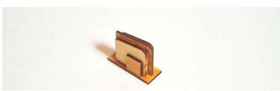
Jetzt sollten die Holzteile mit Porenfüller lackiert und geschliffen werden. Anschließend den Windenkörper weiß oder hellgrau lackieren. Danach den Antriebsmotor (80) und das Spill (81) ankleben.
