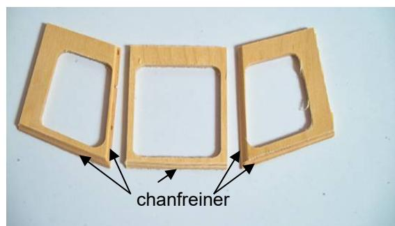
Ensuite il faut ajuster les contours pour le montage du toit. Poncez les arêtes latérales et supérieures des fenêtres selon les rayons des couples et de la face arrière. Poncez maintenant les parties dépassantes des fenêtres.
