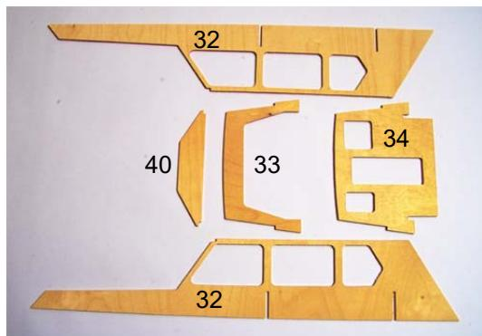
Stecken Sie die Teile probeweise zusammen. Schleifen Sie die Fügezapfen und Schlitte gegebenenfalls etwas nach, sodass die Teile exakt zusammen passen. Kleben Sie jetzt als erstes die Seitenteile, Spant und Rückwand zusammen. Wenn die Klebestellen getrocknet sind wird die Dachverstrebung 40 eingeklebt.
