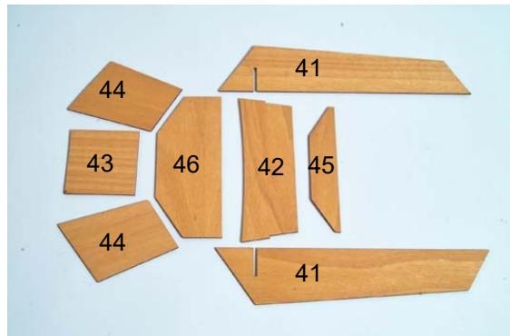
Commencez par coller les pièces 41 et 42 ensembles. Renforcez les coins avec des baguettes pin 3\*5\* 40.
