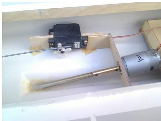
Collez maintenant le tube d'étambot et le support moteur avec UHU Plus Acrylit et remplissez de façon à obtenir une bonne liaison et étanchéité.
