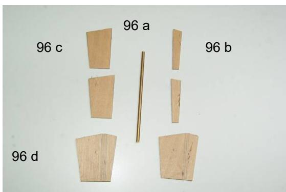
Le gouvernail est fabriqué à l'aide des pièces 96a – 96d. Doublez d'abord les pièces 96b et 96c par collage.
