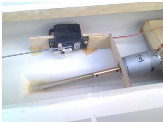
Mit UHU Plus Acrylit wird nun das Stevenrohr und der Motorspant im Rumpf eingeklebt und so verklebt, dass eine gute Verbindung und Abdichtung entsteht.
