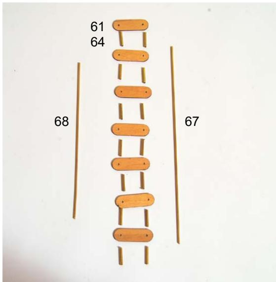
Kleben Sie die ersten beiden Abstandsröhrchen im Abstand von 5 mm am Ende der beiden Handläufe ankleben. Danach abwechselnd eine Stufe und Abstandsröhrchen aufschieben und mit einem Tropfen Sekundenkleber fixieren.
