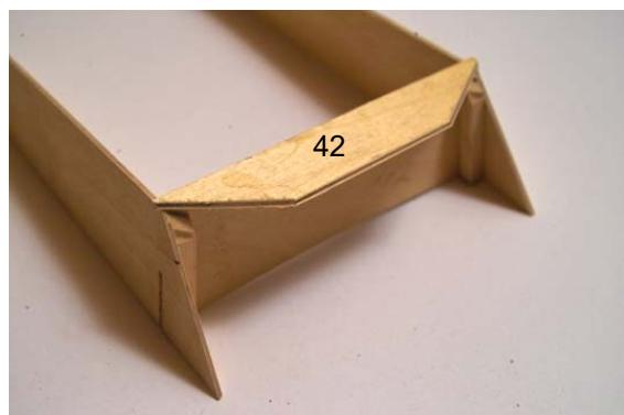
Nun die Flybridge auf das Aufbaudach setzen, ausrichten und mit Sekundenkleber fixieren.
