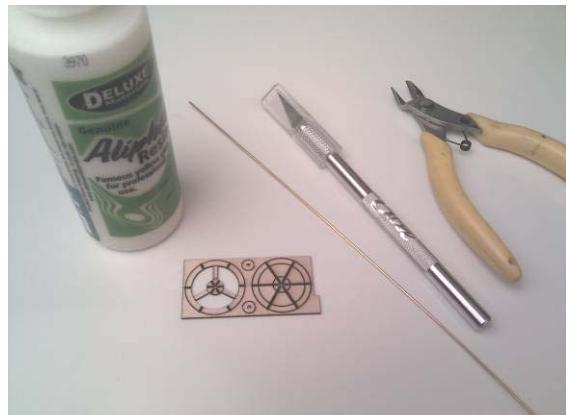
Pour l'assemblage de la roue de gouvernail, il vous faut la petite planchette laser, env. 12cm de fil laiton 1mm, ainsi que de la colle blanche ou aliphate, un couteau à balsa, une pince coupante et du papier abrasif.
