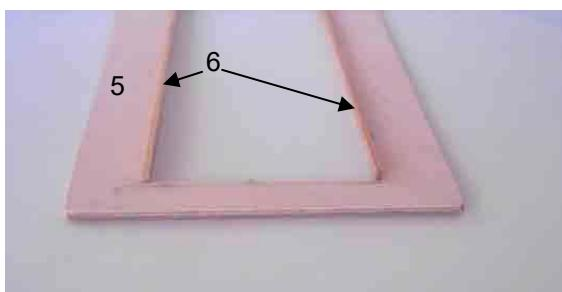
Jetzt den Süllrand (10 bis 14) so gegen die Leisten kleben, dass die Sperrholzstreifen unten bündig sind und über das Deck überstehen. So wird verhindert, dass Spritzwasser in den Rumpf fliesen kann.
