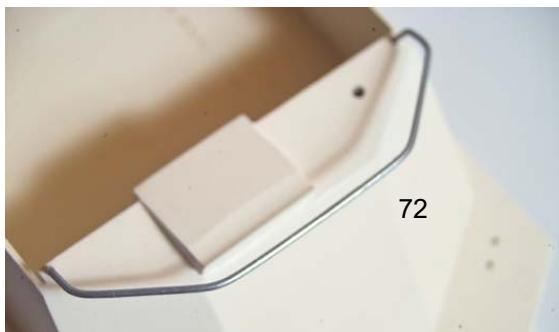
Biegen Sie zunächst die Kontur auf der Aufsicht des Bauplanes passend zu und erst am Schluss die überstehenden Enden nach unten.
