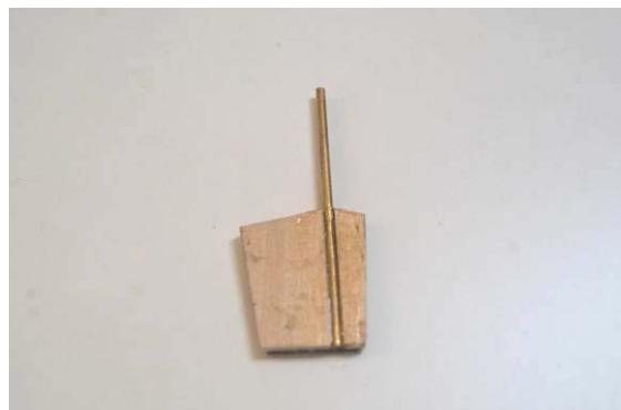
Kleben Sie mit Uhu Acrylit die Ruderachse ein und die zweite Außenseite (96 d) auf.
