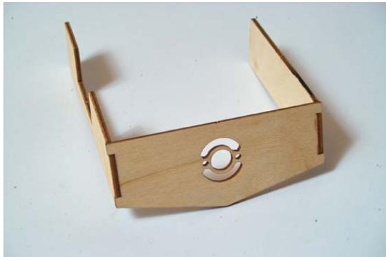
Vous assemblez ensuite les pièces 19, 20 et 21 pour le support d'accu de propulsion et de récepteur.
