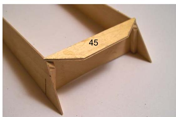
Posez alors le Flybridge sur le roof de la superstructure, ajustez la position et fixez le avec de la colle cyanoacrylate. Ajustez éventuelle-
