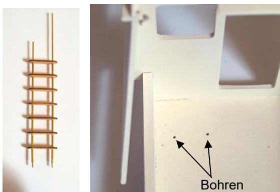
Bohren Sie die Löcher im Plichtboden und positionieren Sie die Leiter ohne zu kleben. Als nächstes biegen Sie das obere Ende des Leiterhandlaufes 30 mm ab.
