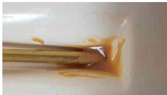
Wenn die Klebeverbindung am Stevenrohr getrocknet ist können der Ruderkoker und die Akkuhalterung im Rumpf platziert und mit UHU Plus Acrylit eingeklebt werden.
