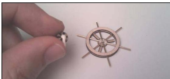
Posez alors le deuxième anneau extérieur sur le premier, de telle façon que les rainures soient positionnées sur les rayons. Mettez un peu de colle sur la deuxième pièce de moyeu et posez-la également sur le moyeu de la première pièce. Pressez l'ensemble de la roue de gouvernail avec un poids, jusqu'à ce que la colle ait durci.
