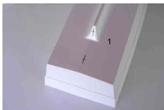
Percez maintenant les trous pour le tube d'étambot et l'étambot de gouvernail. Commencez avec un petit foret env. 2 – 3 mm par un avant-trou, puis agrandissez à la bonne cote – étambot de gouvernail 4 mm et tube d'étambot 7 mm. Ceci de préférence avec une lime ronde, pour ne pas créer de fissures dans la coque.
