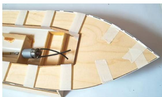
Fixer le pont par points avec la colle cyanoacrylate fluide. Collez ensuite toute l'arête du pont avec la colle cyanoacrylate moyenne. L'utilisation d'un activateur améliore le collage.
