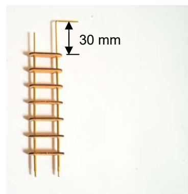
Biegen Sie die Relingstütze aus Brass Wire 1,5 x 45 mm (69).
