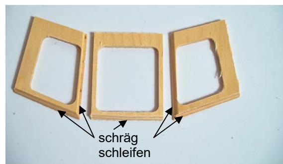
Als nächstes werden die Konturen für die Dachmontage angepasst. Schleifen Sie die Seitenkanten und die Oberkante der Fenster entsprechend des Spant- und Rückwandradius. Die Überstände der Fenster sind jetzt abzuschleifen.
