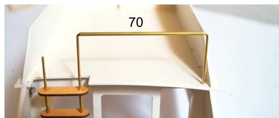
Fabriquez la traverse inférieure avec 2 gouilles (71) et un tube (70).
