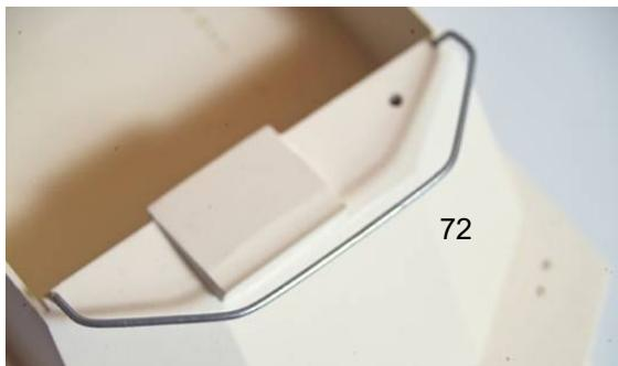
Pliez d'abord le contour de la vue de dessus du plan, puis finissez avec les bouts verticaux vers le bas.
