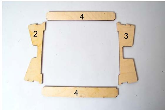
Fertigen Sie aus den Teilen 2, 3 und 4 den Bootsständer. Anschließend wird der verleimte Ständer sauber verschliffen und wasserfest lackiert. Die wasserfeste Lackierung ist besonders wichtig, da im späteren Fahrbetrieb hier
