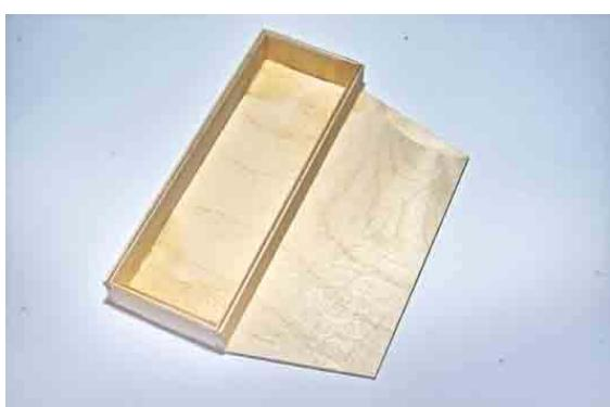
Toutes les pièces sont maintenant prêtes à être collées dans la coque. Traitez ces pièces 2 à 3 fois avec du bouche pores, avec un ponçage intermédiaire. Ensuite ces pièces sont peintes avec une peinture résistant à l'eau. Traitez également la face inférieure du pont avec une peinture résistant à l'eau.
