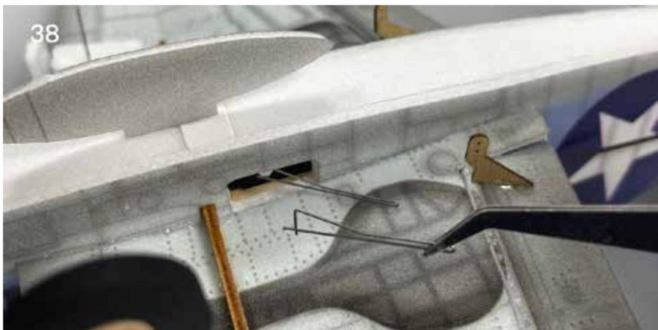
39. Verbinden Sie die Drahthaken mit Schrumpfschläuchen.
