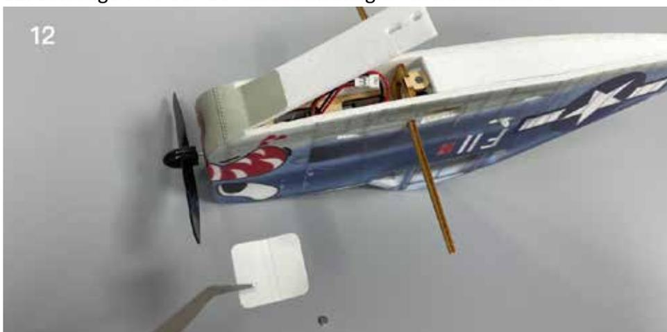
13. Die Batterieabdeckung kann geöffnet werden und kann in der geschlossenen Position durch Magneten befestigt werden.
