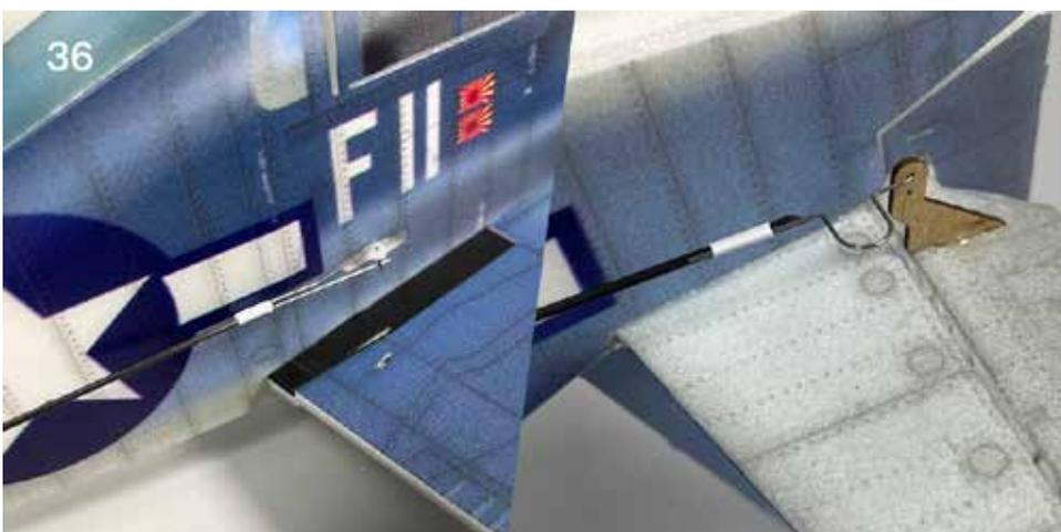
37. Verwenden Sie einen Schrumpfschlauch, um die Stahldrahtclips der Querruder zu verbinden.
