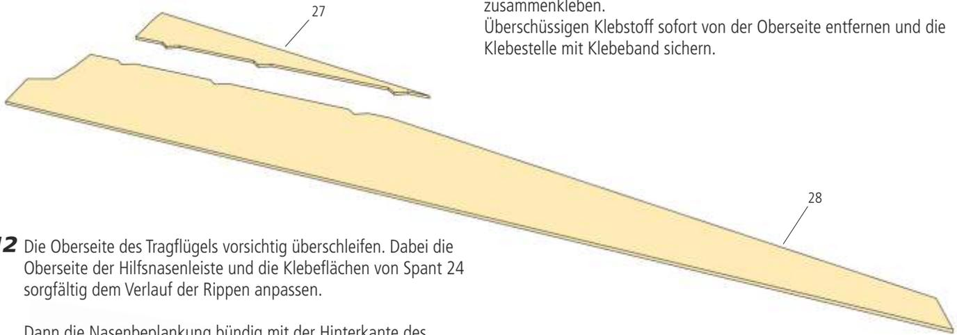
**12** Die Oberseite des Tragflügels vorsichtig überschleifen. Dabei die Oberseite der Hilfsnasenleiste und die Klebeflächen von Spant 24 sorgfältig dem Verlauf der Rippen anpassen.
