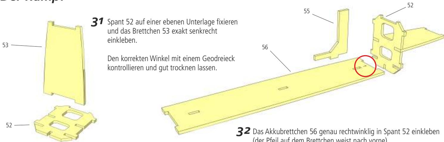
**31** Spant 52 auf einer ebenen Unterlage fixieren und das Brettchen 53 exakt senkrecht einkleben.
