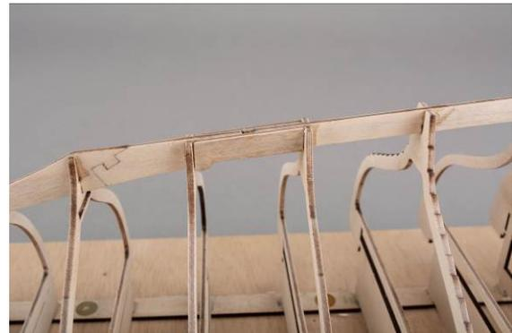
Abb.: Verstärkung Kielbolzen vorne
