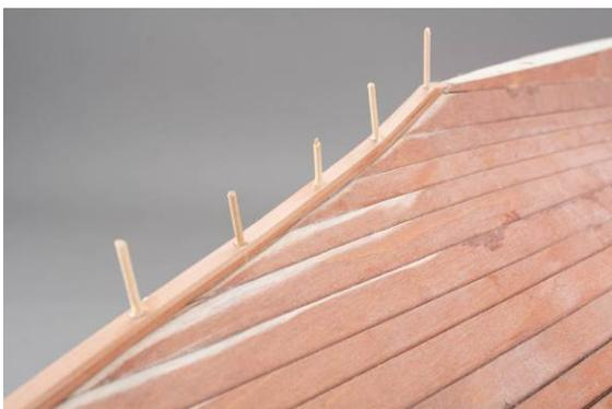
Abb.: Verschließen der Schraubenlöcher
