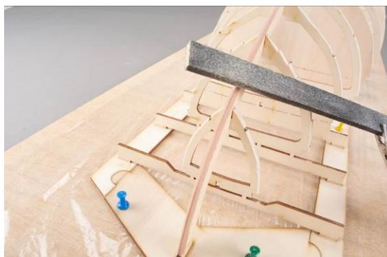
Abb.: Kieleisten und Spanten anschrägen – straken
