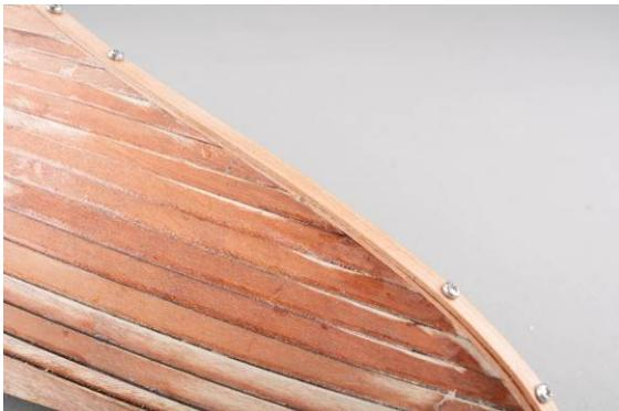
Abb.: Leisten aufgeklebt
