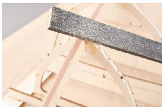
Abb.: Spanten straken
