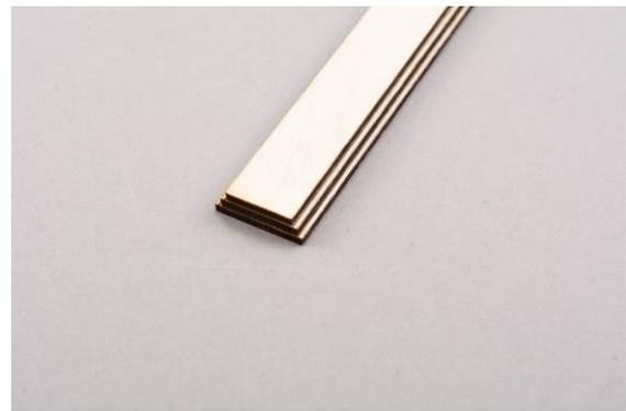
Abb.: stufig aufeinander geklebte Masthälfte
