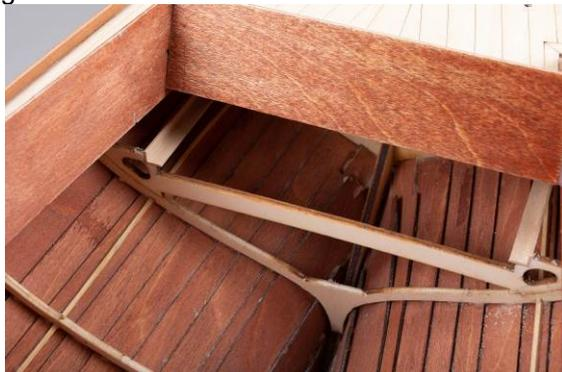
Abb.: Führungen eingeklebt
