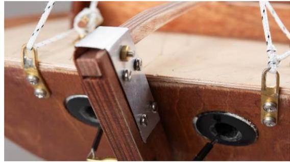
Abb.: Anbringung der Befestigungslaschen
