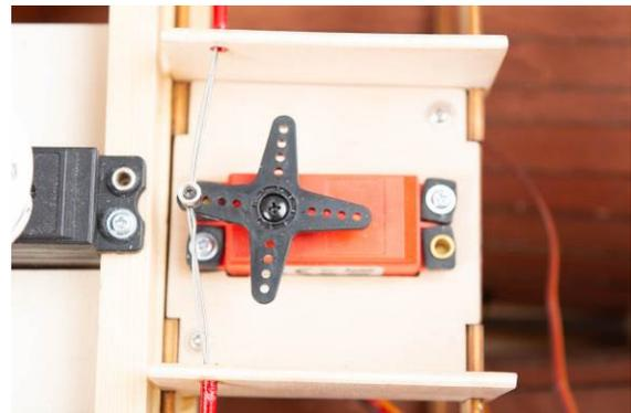
Abb.: Servo befestigen
