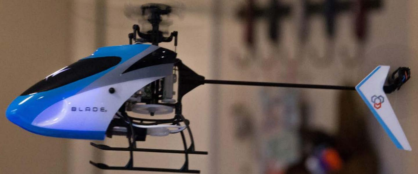
Mit dem Nano CP S brachten die Blade-Entwickler erstmals die SAFE®-Stabilisierungstechnologie auf einer Nano-Heli-Plattform. Bei Kontrollverlust konnten Piloten einfach den Panik-Knopf drücken. Die SAFE®-Technologie setzte sofort ein und rettete das Modell in einer neutralen Fluglage.
