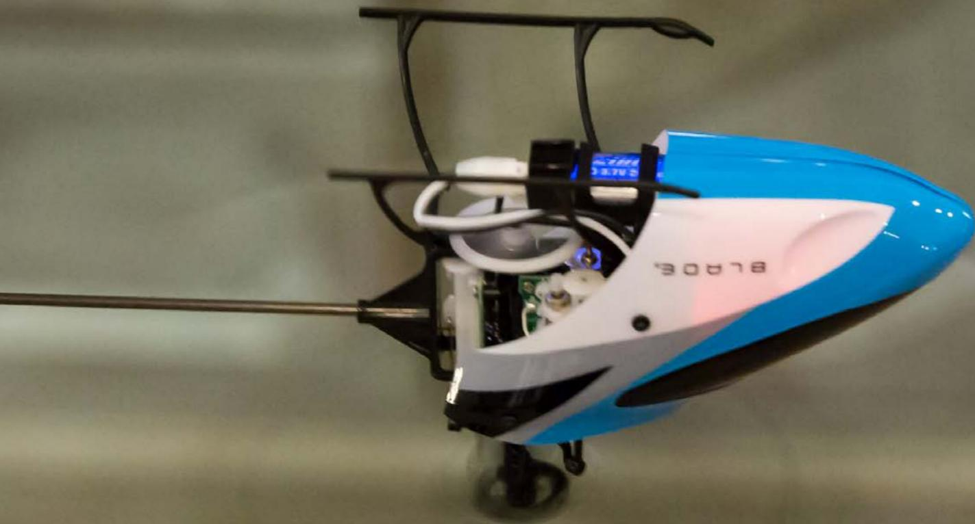
und Panik-Funktion. Die SAFE Z Flughöhen-Kontrolle ist ein neues System der Nano-Plattform und verwendet den integrierten Beschleunigungssensor des Heli, um eine konstante Höhe zu halten. Der neue Flight Controller wurde dafür vertikal montiert, um die Dämpfung zu verbessern und Vibrationen für den Kreisel zu beseitigen.
