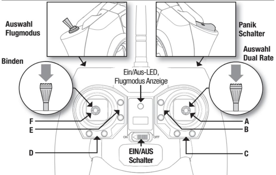
Wenn die Trimmasten gedrückt werden, geben sie einen Signalton von sich, der bei jedem erneuten Drücken höher oder tiefer wird. Die mittlere oder neutrale Trimmstellung erklingt in der mittleren Tonhöhe. An den äußeren Enden des Steuerbereichs erklingt eine Tonfolge.
